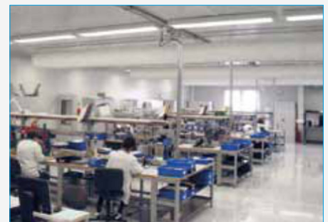
Montage von Miniaturgetrieben im Sauberraum
