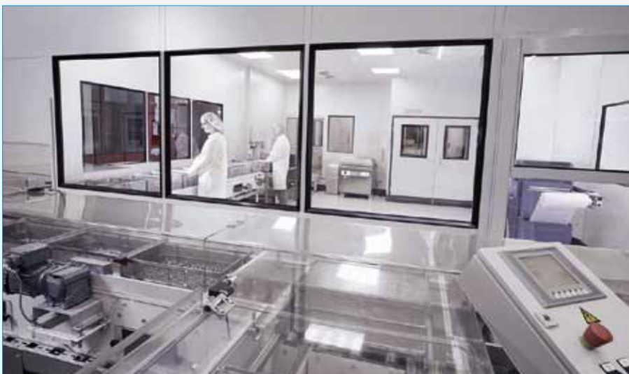
Gekapselte Förderbänder mit Anbindung an den Reinraum
