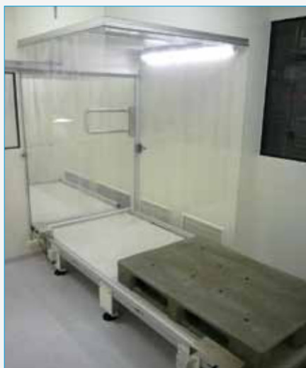
Probenzugkabine mit Laminarflow und Fördertechnik
